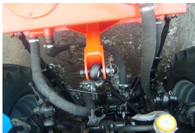
Рис. 8. Соединение насосов НШ-50 и НШ32А-3 с гидробаком
