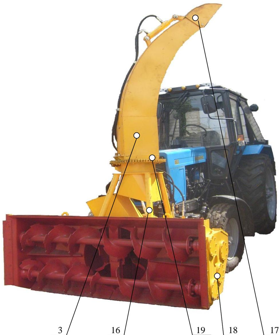
**Рис.3. Оборудование шнекороторное снегоуборочное ШРК-2,0-01 с установкой на базовый трактор.**
