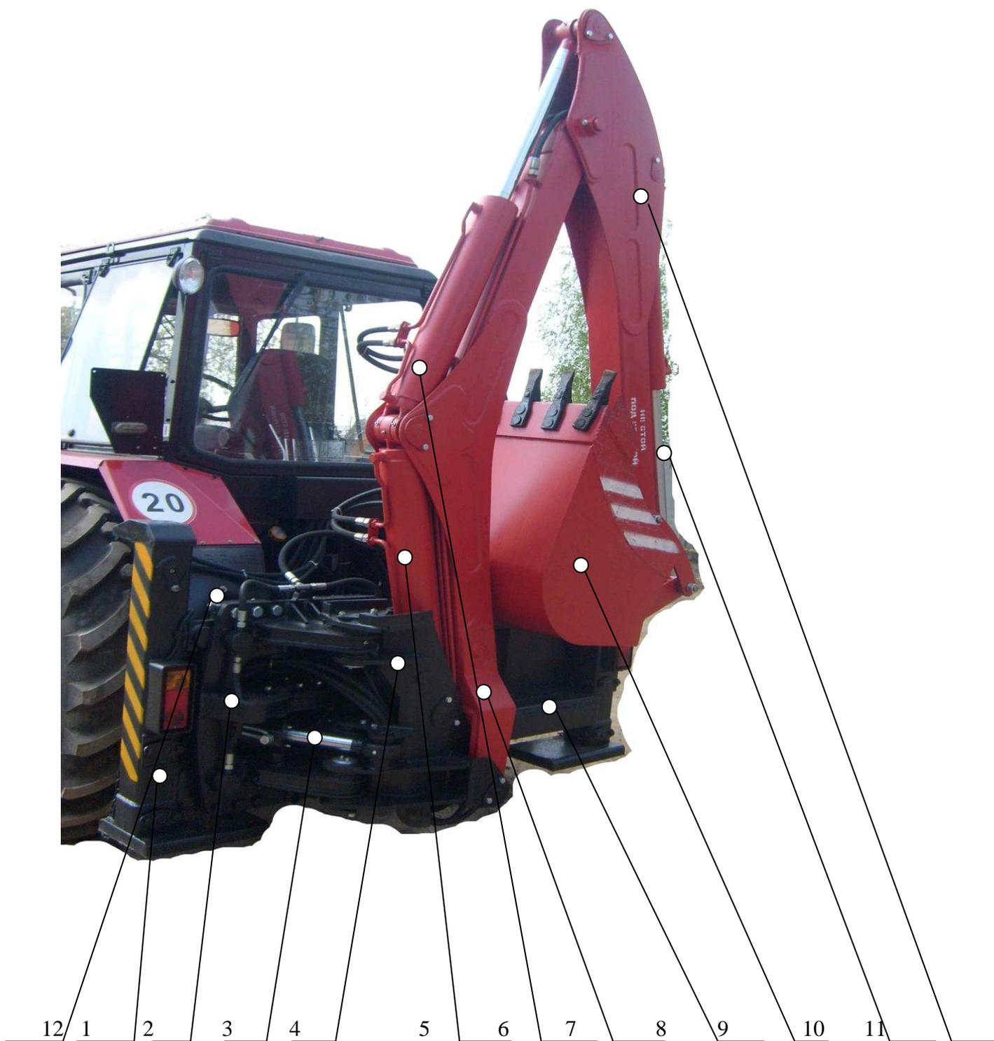
**Рис.1 Общий вид и основные узлы экскаваторного оборудования**
