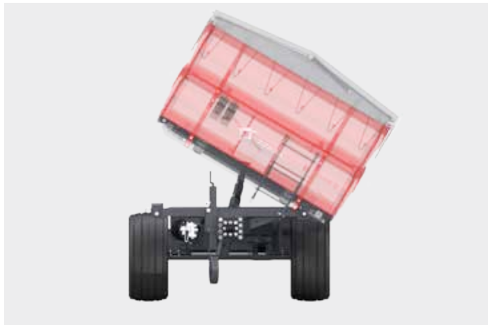
Трехстороннее опрокидывание 35/35° (назад / на стороны)
