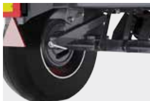
Стояночный ручной тормоз с кривошипной рукояткой
