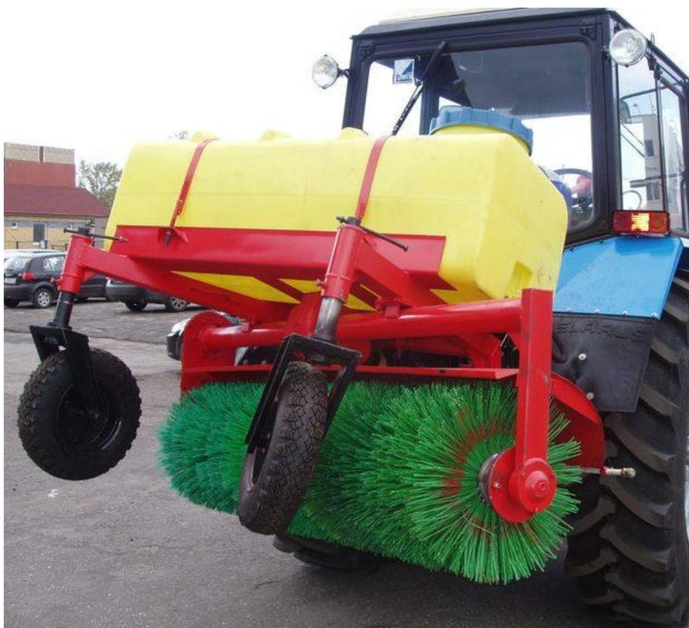
Рисунок 2. Общий вид Оборудования щеточного исполнения УМДУ-80/82.02 ЛЮКС ПМ.
