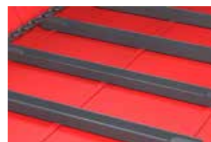
Пол с гидравлическим приводом и с возможностью регулирования скорости
