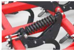
Винтовая защита - защита рабочих органов от перегрузок
