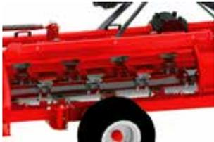
Откидывающаяся заслонка выгрузки - Позволяет разбрасывать скошенную массу. Предотвращает скопление скошенной массы внутри машины.
