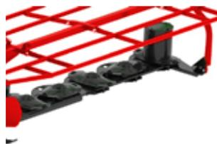
Каждый диск имеет защиту в виде выделенной зоны разрыва, и в случае столкновения диск отключается от системы передачи крутящего момента.
