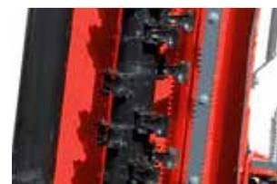
Оснащение машины - Цепные молотилки. Быстрая и простая замена цепных молотилок
