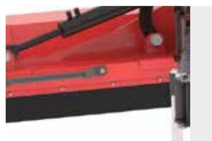
Металлический бампер - Обеспечивает дополнительную защиту машины от повреждений.
