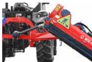
Регулировка высоты скашивания - Копирующий вал регулирует высоту скашивания от 2 см до 8 см.
