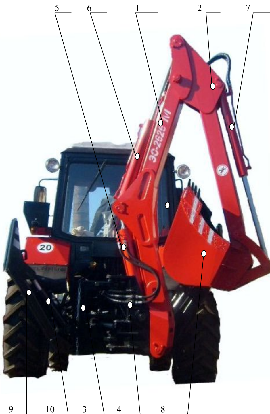
Рис.1 Общий вид и основные узлы экскаваторного оборудования.
