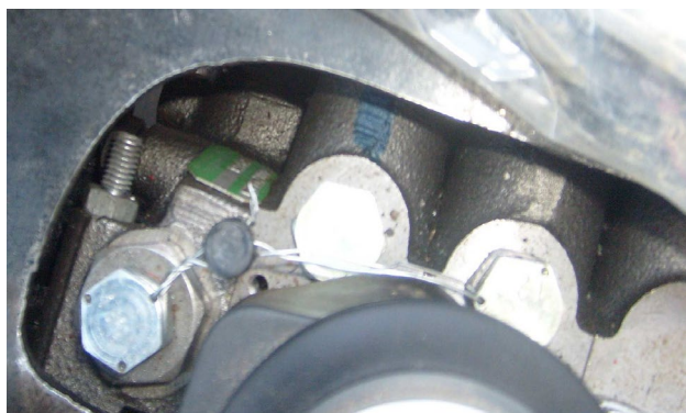
Рис.2 Пломбирование гидрораспределителя (в кабине, со стороны рабочего места оператора).
